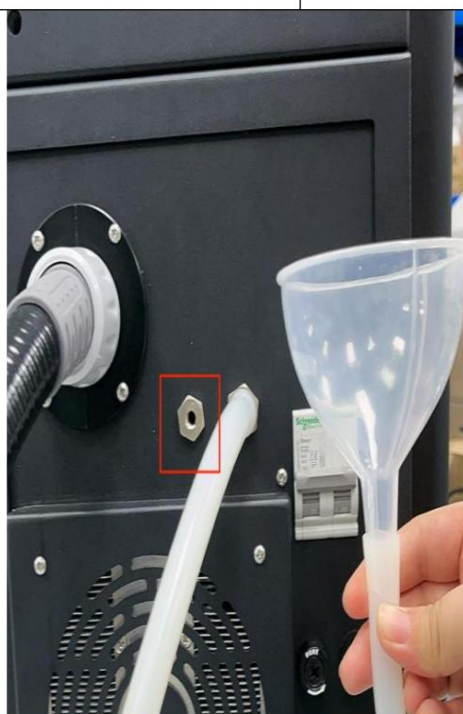
3. חבר את המשפך לכניסת המים, והוסף מים מזוקקים או מים טהורים למכונה עד שהמים מגיעים החוצה מהפתחים, זה אומר שהמכונה מלאה במים, ואז סגור את כניסת המים ואת פתחי האוורור.
